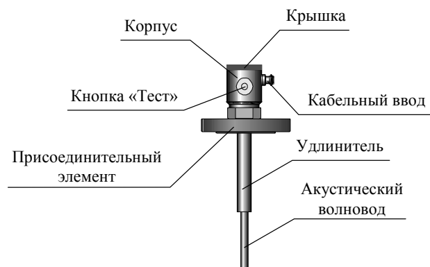
Рис. 2. Сигнализатор уровня ASL-400
