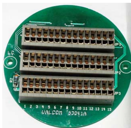
Рис.6. Вид платы коммутатора датчика T7MPX.
